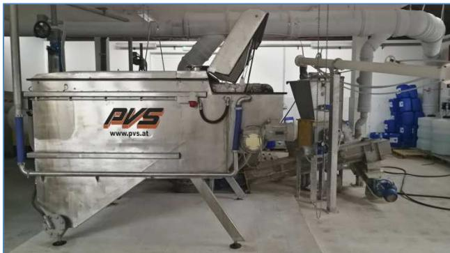
Jedinica za mikrofiltraciju
