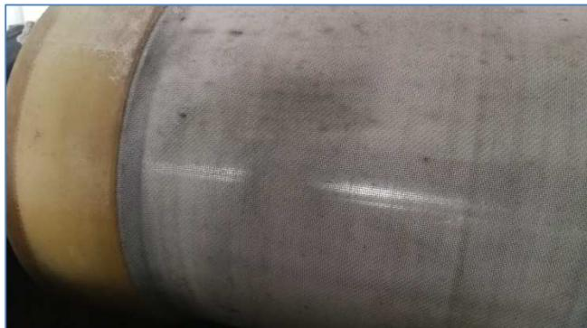
Mikrosita sa svijetlim otvorom od 350 µm
